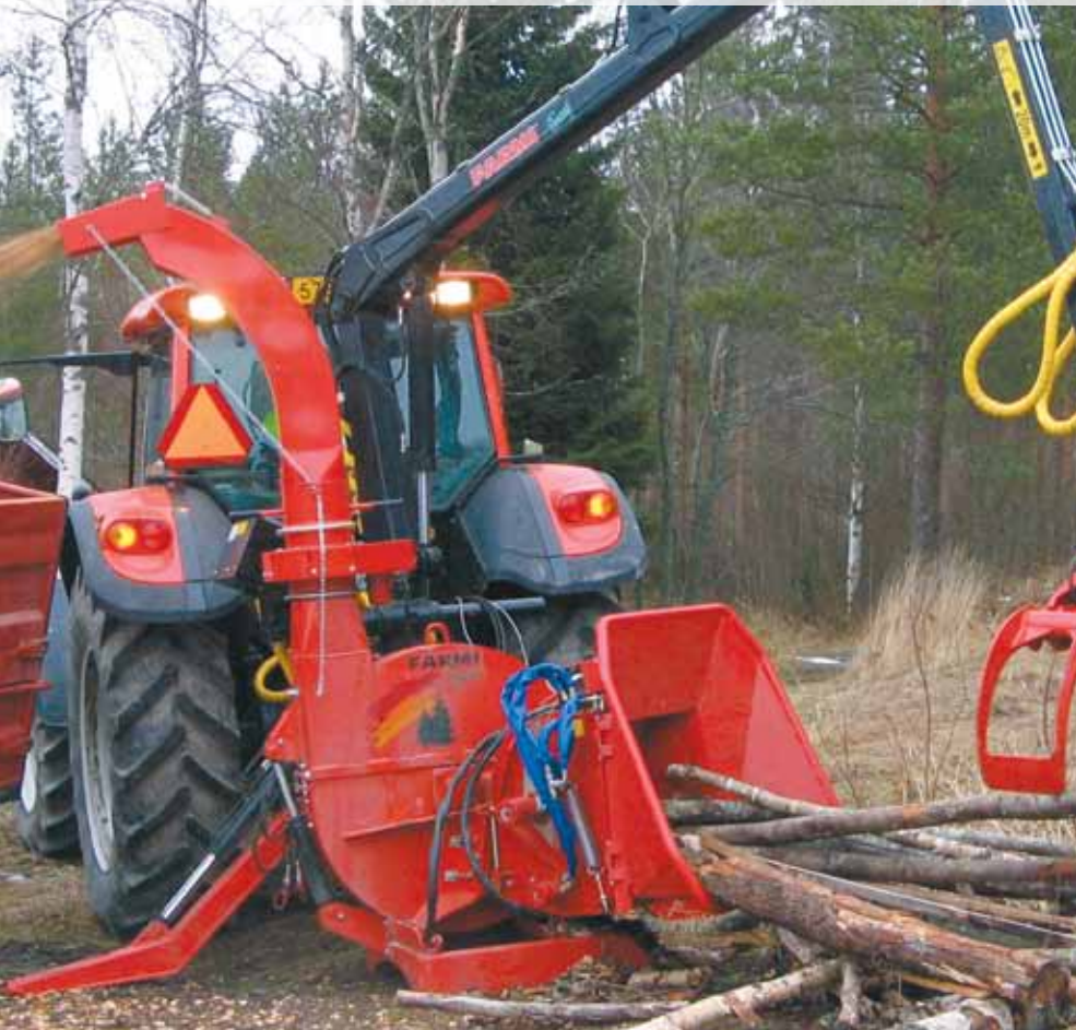
Farmi 260 HFEL (электро-гидравл. устройство подачи с двумя роликами)
