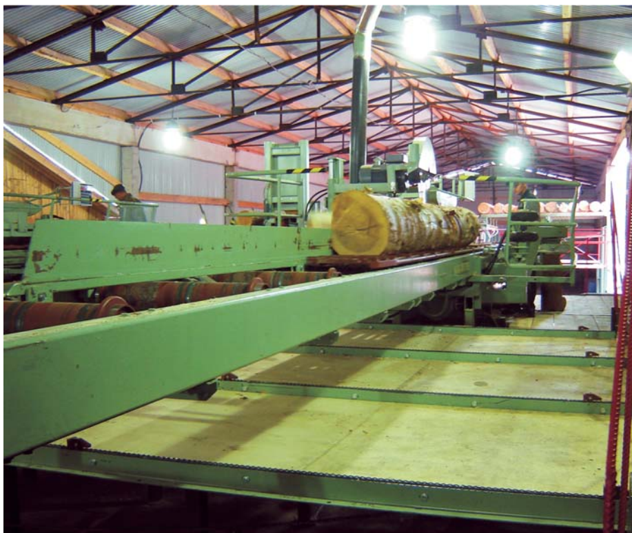
Бревнопильный станок KARA-Master с верхним пильным диском и однооператорным оснащением
